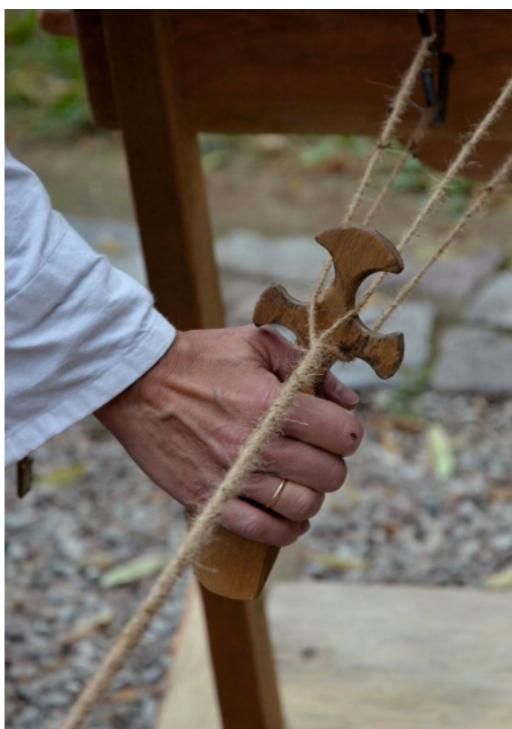
skręcanie pojedynczych sznurków w linę
