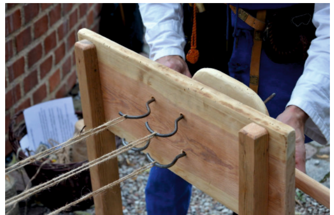
rekonstrukcja skrętarki do lin
