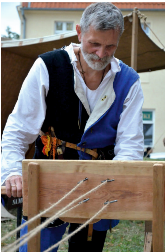
skręcanie pojedynczych sznurków przy pomocy skrętarki
